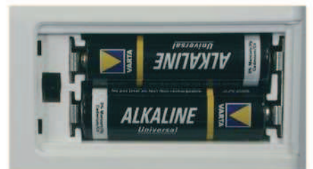
Funzionamento con 2 pile stilo di Tipo AA
